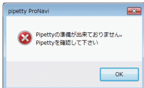
また、ピペット本体がモード選択 “S” 点滅時以外の場合や、ピペット本体の準備が整っていない場合、本アプリケーションによるリモートモードに切り替わらず、左図のメッセージが表示されます。
