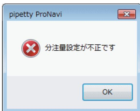
※最初に、使用するピペット本体の容量“pipetty Vol.”を選択して下さい。選択しない場合、分注量チェックにより入力が出来ず、エラーメッセージが表示されます。
