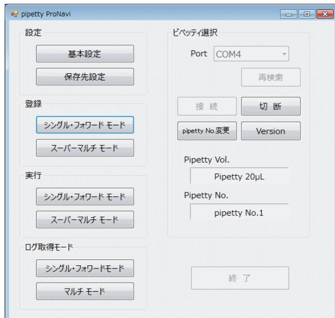
●ここで、“pipetty Vol.”には、接続したピペット本体の容量、“pipetty No.”には、接続したピペット本体のシリアルナンバーが表示されます。
