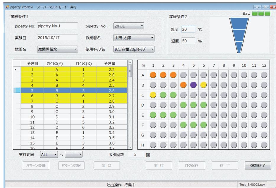
一回の吸入での一連の吐出作業が終了すると、「残吐出操作を実行して下さい」のメッセージが表示されます。
